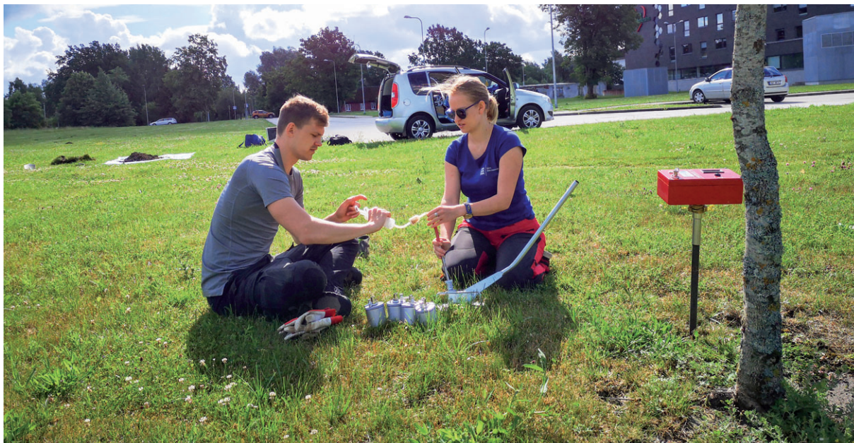
Tudengid Elina Kuusma ja Markus Kivimägi täidavad pinnaseõhuga RM-2 kolbe, punane Markus 10 pumpab ise õhu pinnasepooridest oma ionisatsioonikambrisse. Foto: Krista Täht-Kok.
