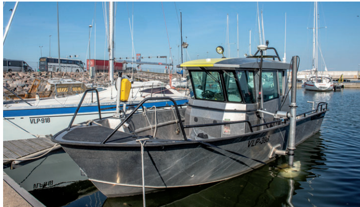
EGT uurimispaat Kuivastu sadamas. Poordis põhjaprofiilaatori Chirp kiirgur-vastuvõtja.
