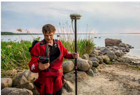
Mererannikute seire tööd: mõõdistamine RTK-GPS seadmega ja setete puurimine.
