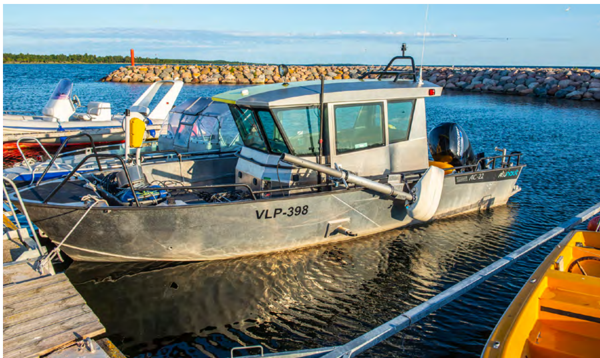
EGT uurimispaat. Pakpoordis põhjaprofilaator Chirp.
