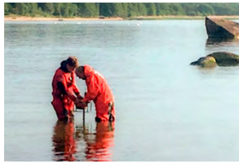
Mererannikute seire tööd: mõõdistamine RTK-GPS seadmega ja setete puurimine.
