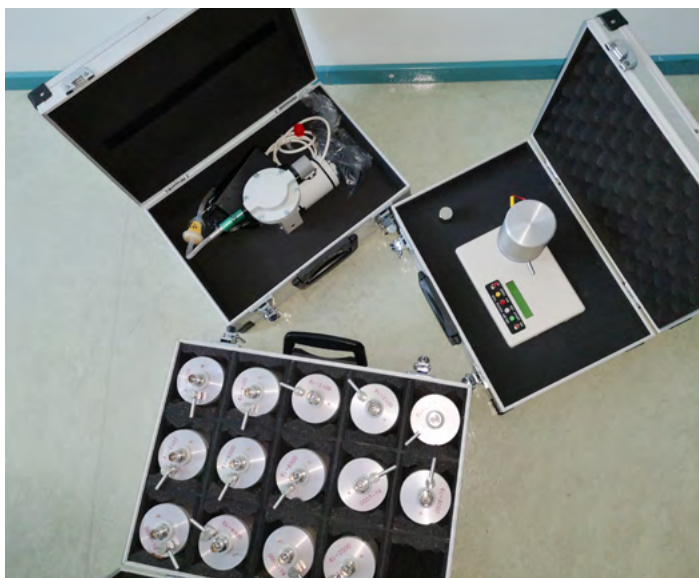
Kolmeosaline Rn-mõõtmisüsteem RM-2 võimaldab Rn-proovid kolbidesse koguda ja hiljem koos analüüsida, kuid kõrgete Rn-sisalduste korral tuleb ka RM-2ga töötades jälgida kolbide radooniga saastumist.
